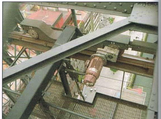
動力の変更—車輪ごとに独立したモーター
