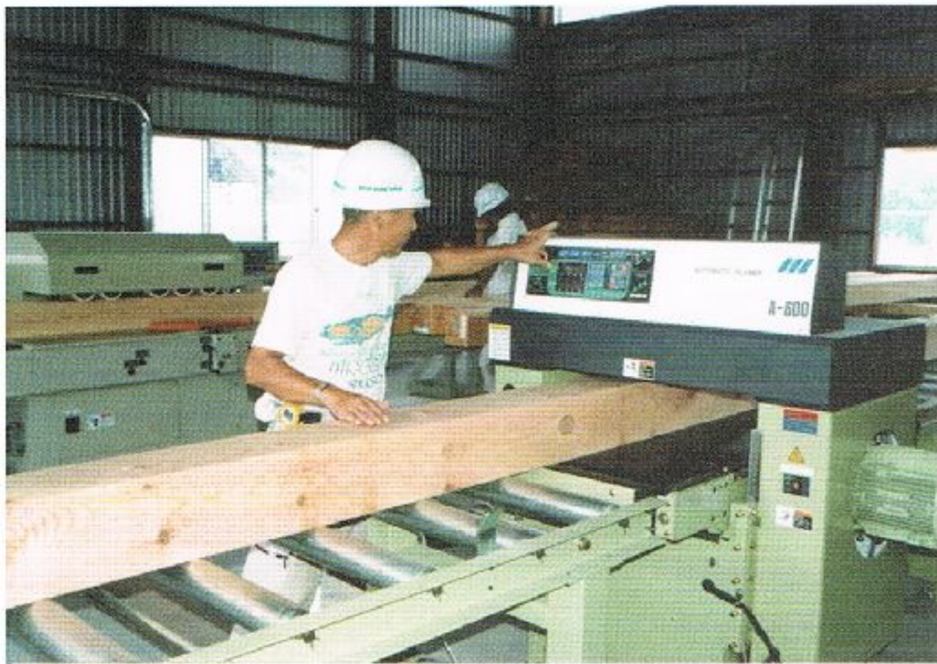
写真 6.7-5 一面自動加工状況(岩国市撮影)
