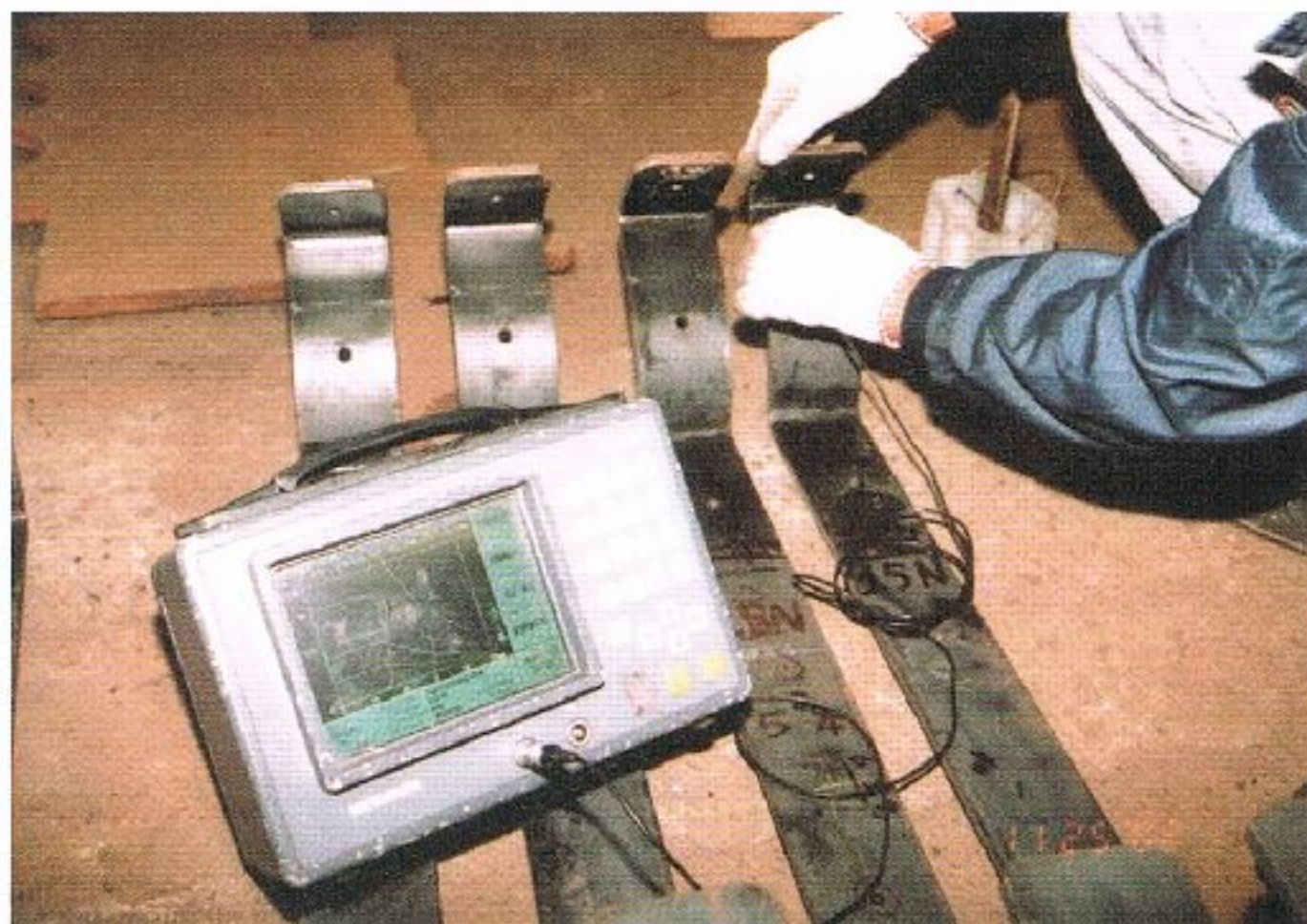
写真 6.7-58 超音波探傷試験(岩国市撮影)
