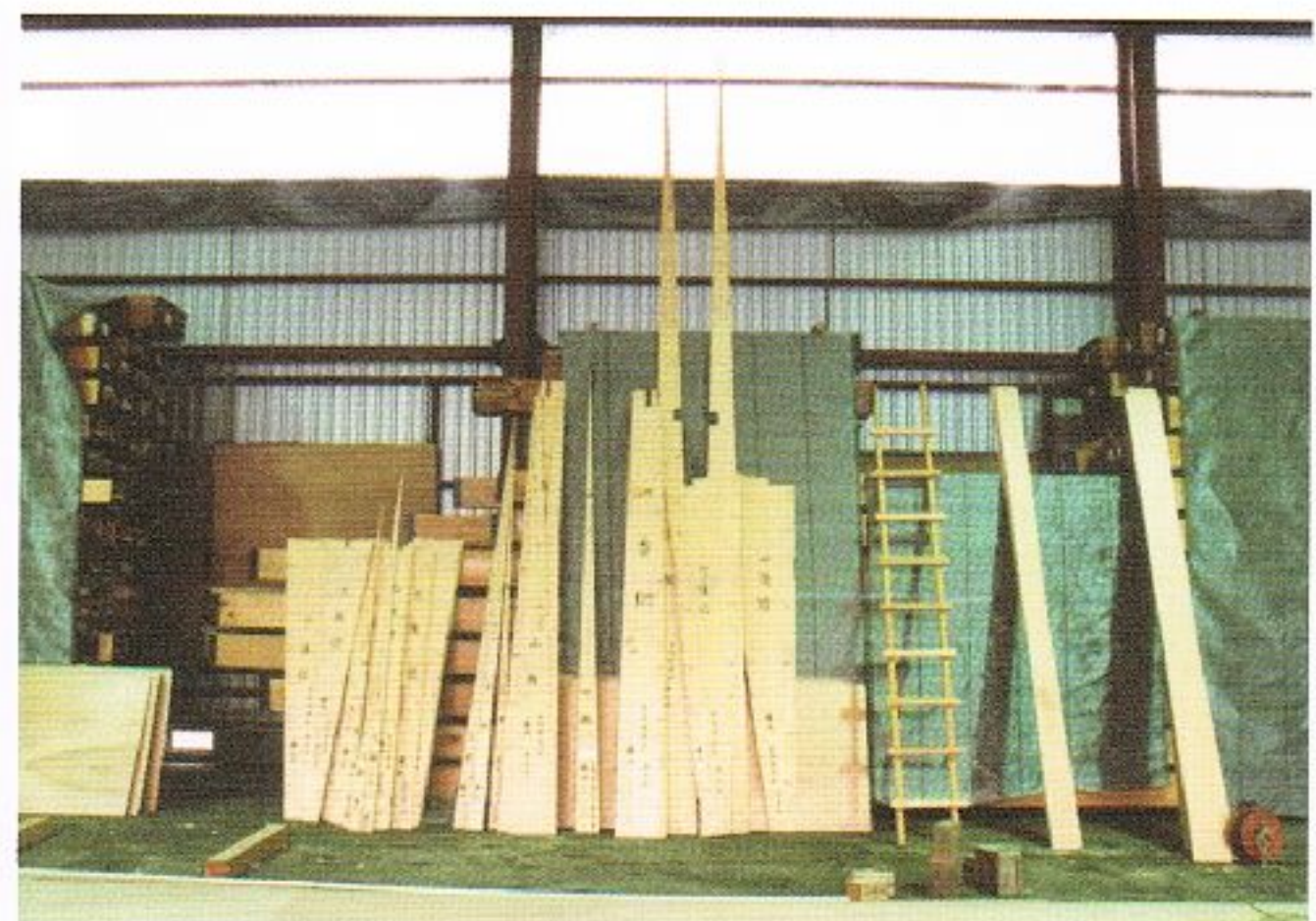
写真 6.7-4 現寸型板(岩国市撮影)
